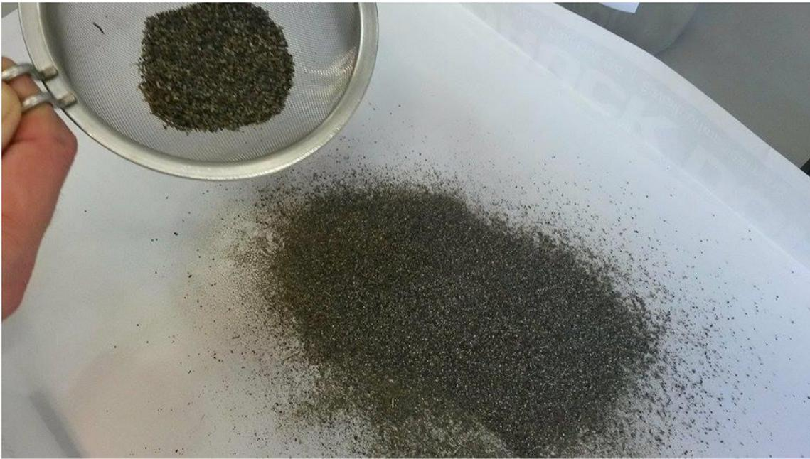
**Abbildung 13: Siebung mit feinmaschigem Sieb (Maschengröße 1 mm) (eigenes Bild).**
