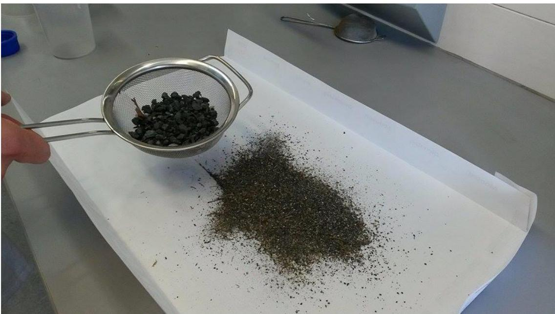
Abbildung 12: Siebung mit grobmaschigem Sieb (Maschengröße 1,5 mm) (eigenes Bild).
